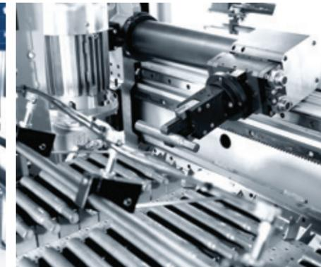
Taktförderband mit Prismenauflagen für unterschiedlich vorgeformte Wellenteile.
