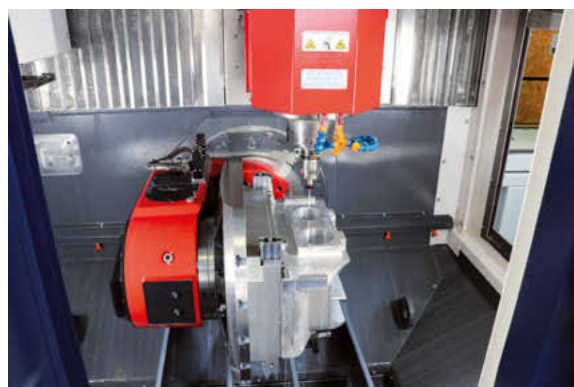
Die Emco Maxxmill 750 wird bei Friedrich nicht nur für die Serienproduktion eingesetzt. Dank flexibler Belademöglichkeiten von vorne und oben kann die Vertikal-Fräsmaschine auch größere und komplexe Einzelteile fräsen.
