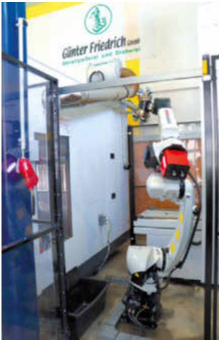
Die mit der Emco Maxxmill 750 „verheiratete“, robotergestützte Tower-Lösung von Robojob ermöglicht es, rund um die Uhr Bauteile zu bearbeiten. Bild: Emco
