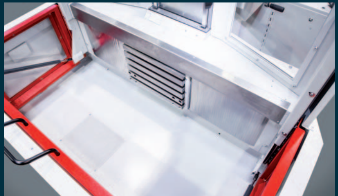
Versenkbarer Arbeitsschutz mit senkrechter Aufspannfläche.
