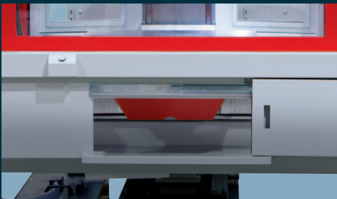
An der Maschinenfront gibt es eine großzügige Spänetür für eine problemlose Entsorgung der Späne.
