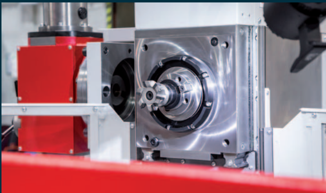
Wechsel auf Horizontalfräsen. Horizontale Frässpindel DIN69871 SK40
